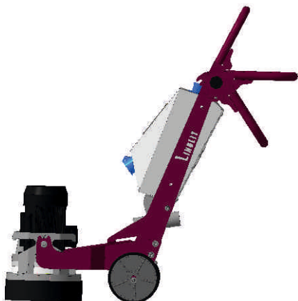
Рис. 4 Регулировка положения рукояти
