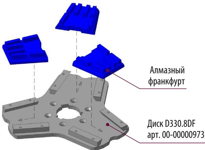
Рис. 15 Установка алмазных франкфуртов
